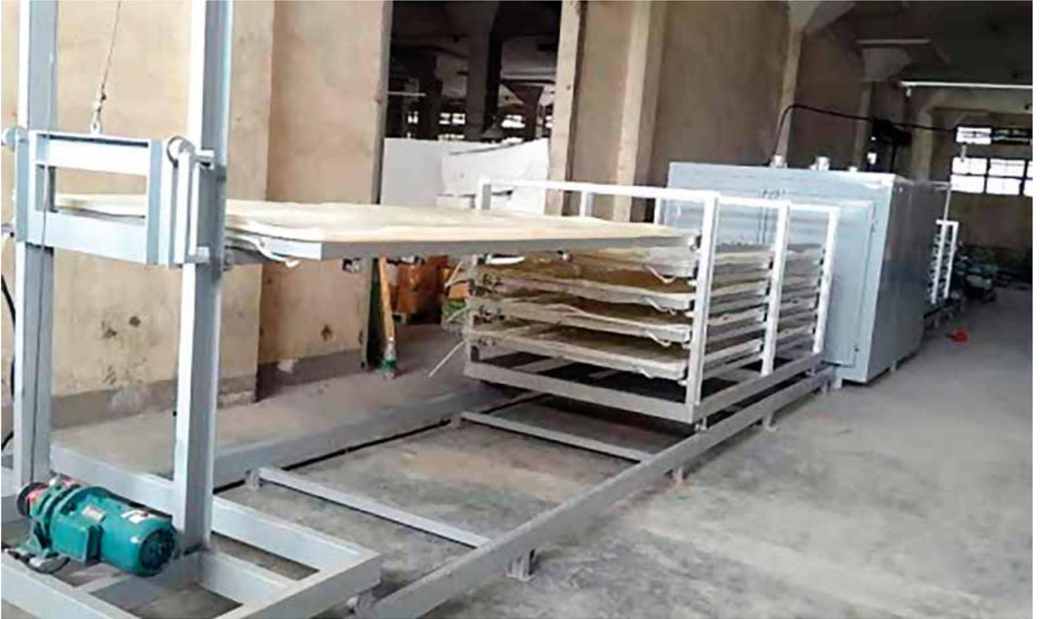
***Nuestro horno de vidrio laminado, utiliza el principio de la bolsa de vacío para calentar el material de pegado junto con el vidrio, para que los pedazos de cristal se peguen juntos, formando una sola unidad con mayor resistencia y durabilidad.***
